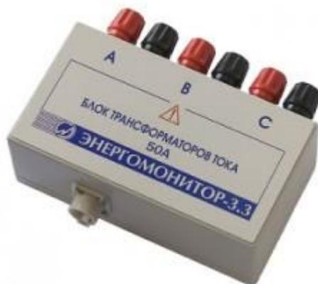
Предназначен для масштабного преобразования трехфазного тока при работе с прибором «Энергомонитор 3.3Т1 (-С)», который в комплекте с БТТ измеряет активную электрическую мощность с относительной погрешностью  $\pm 0,1\%$ .
