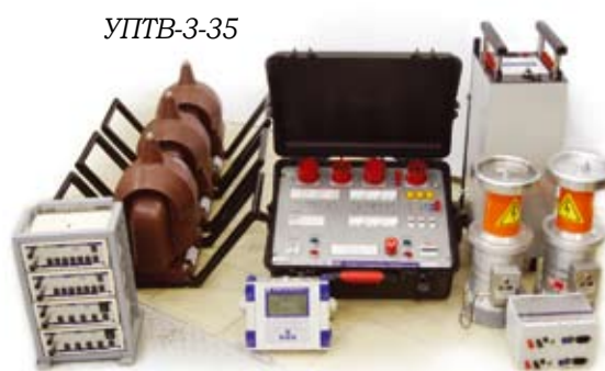
Поверка трехфазного НАМИ-35 с применением УПТВ-3-35
