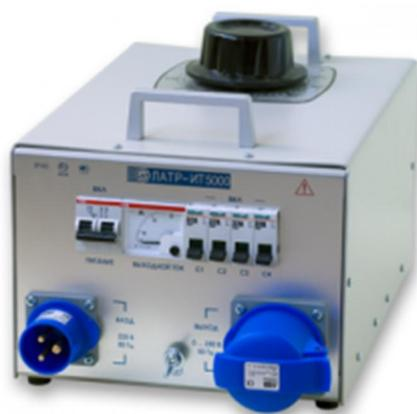
Регулируемый источник тока «ИТ5000» используется для обеспечения подачи переменного тока в первичную цепь эталонного и поверяемого трансформаторов тока (ТТ) в диапазоне 0-6000 А при проведении поверки ТТ по ГОСТ 8.217
