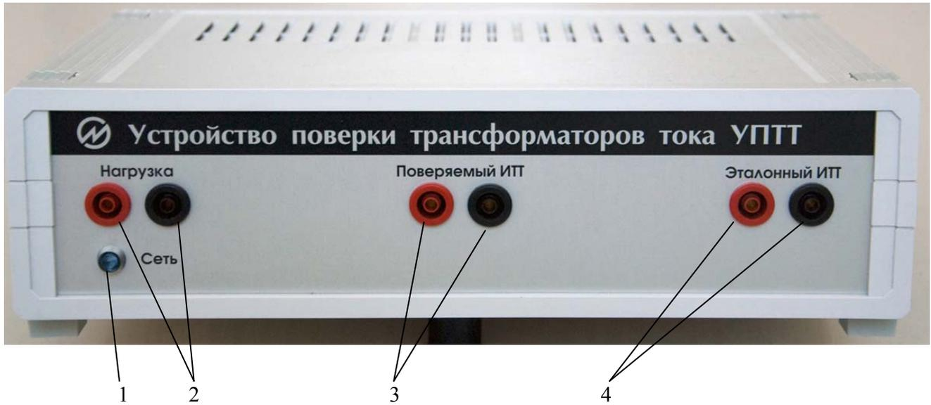
Рисунок 3.3. Лицевая панель устройства поверки трансформаторов тока УПТТ
