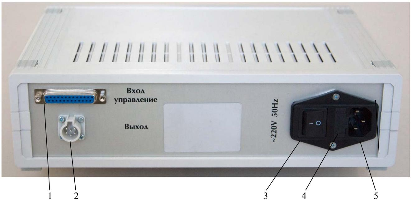
Рисунок 3.4. Задняя панель устройства поверки трансформаторов тока УПТТ
