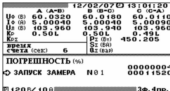
Рисунок 4.4.5 Окно поверки счетчика
