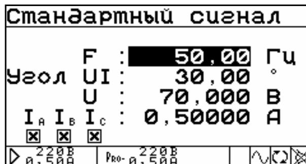
Рис. 4.5. Окно задания параметров стандартного сигнала
