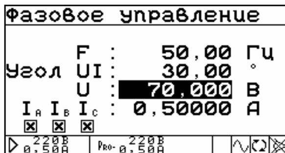
Рис. 4.18. Окно задания параметров фазового управления
