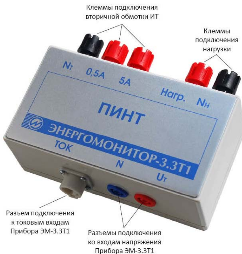
Рис. 4.47. Внешний вид и разъемы для подключения внешних устройств ПИНТ
