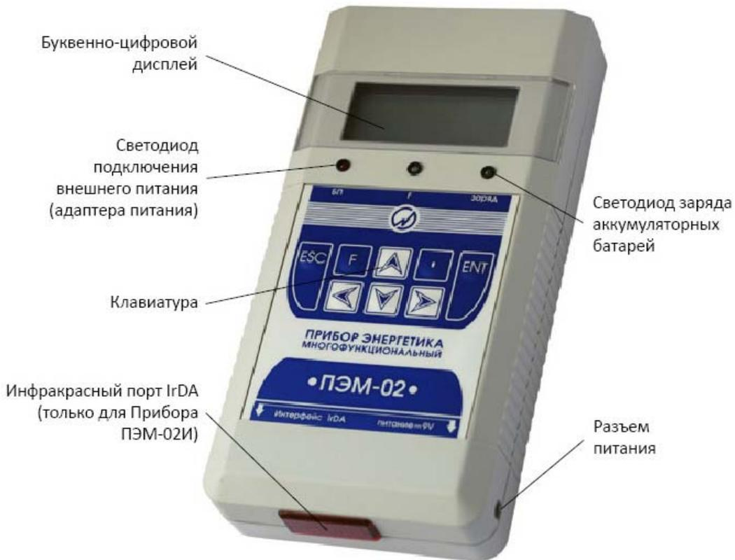
Рис. 3.1. Передняя панель Прибора ПЭМ-02
