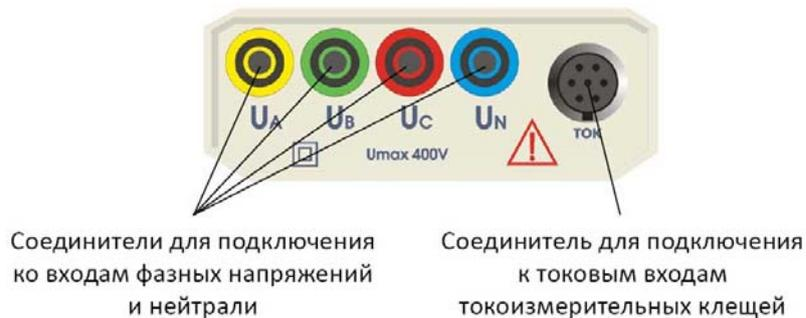
Рис. 3.2. Верхняя панель Прибора ПЭМ-02
