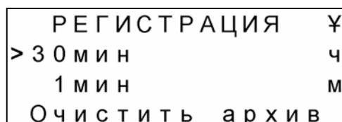
**Рис. 4.16.** Экран выбора времени усреднения в режиме регистрации параметров электросети
