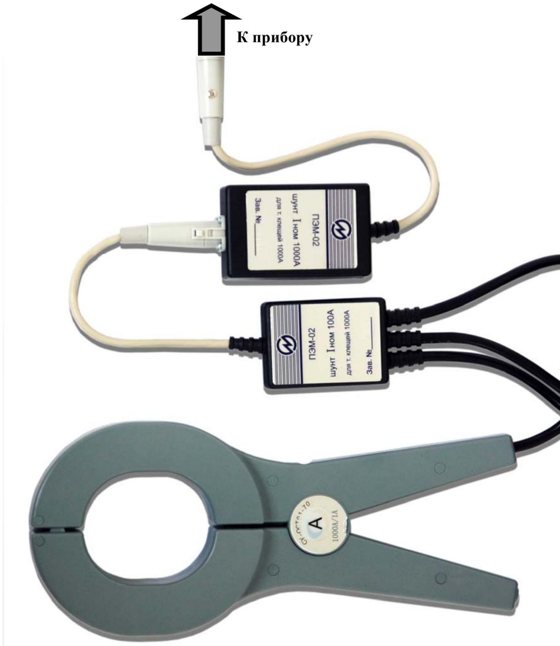
**Рис. А.7.** Схема подключения токоизмерительных клещей 1000 А к Прибору ПЭМ-02 через шунты  $I_n = 100 \text{ А}$  и  $I_n = 1000 \text{ А}$  для измерений на пределе 1000 А
