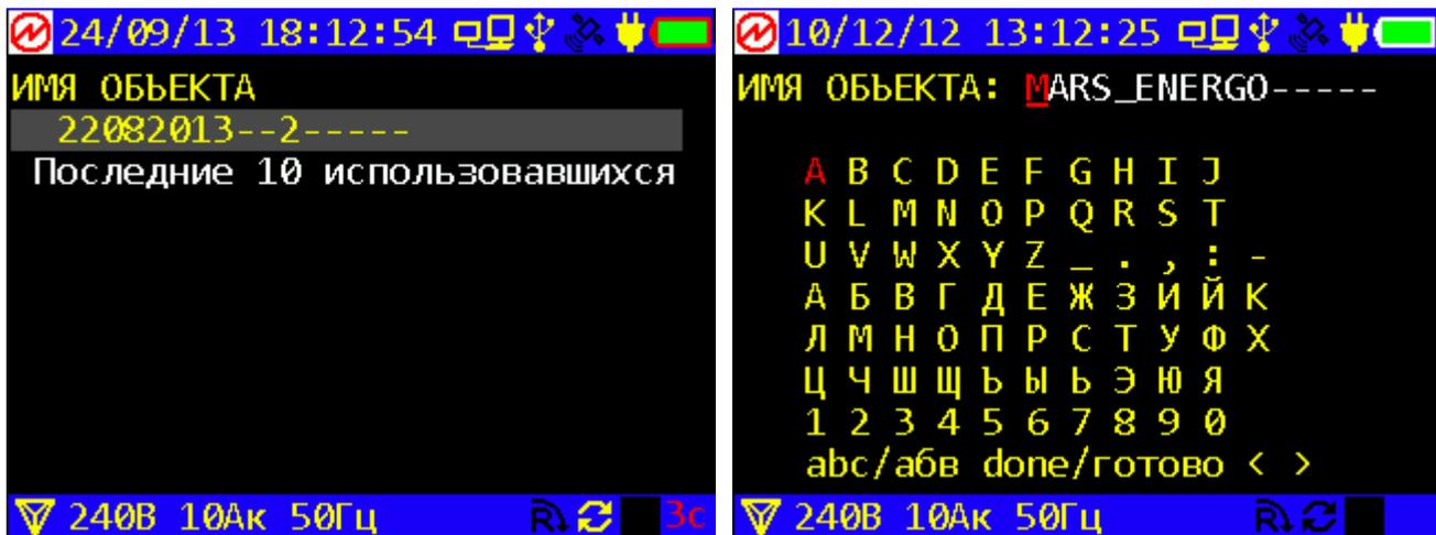
Рисунок 4.3.2 Экраны для выбора и создания имени объекта
