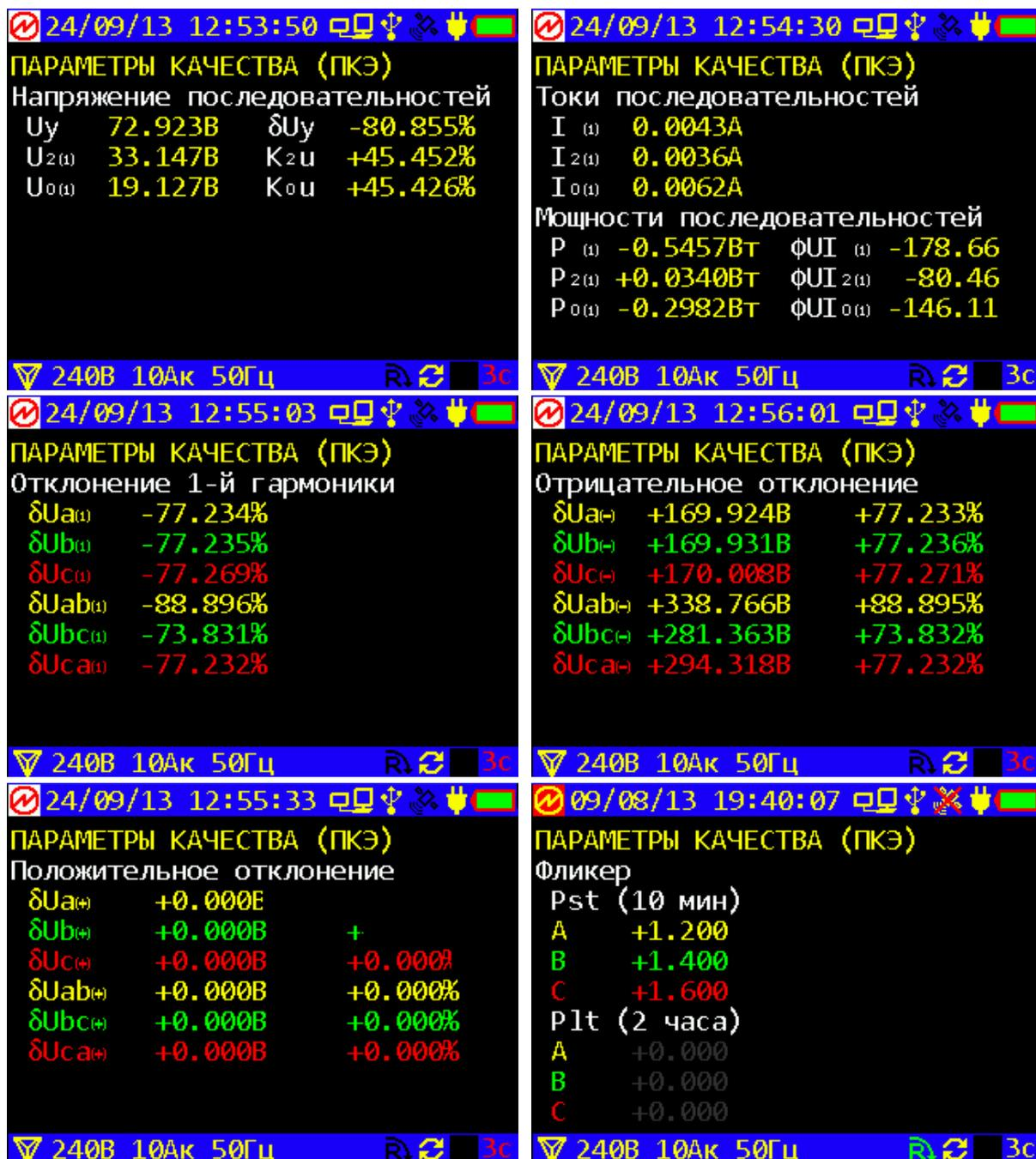
Рисунок 4.2.4 Экраны режима отображения текущих ПКЭ
