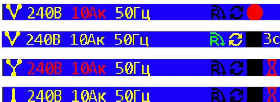
Рисунок 4.1.3 Символы нижней строки состояния Энерготестера ПКЭ
