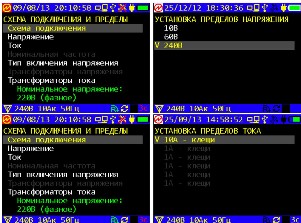
Рисунок 4.4.3 Экраны для выбора пределов напряжения и тока
