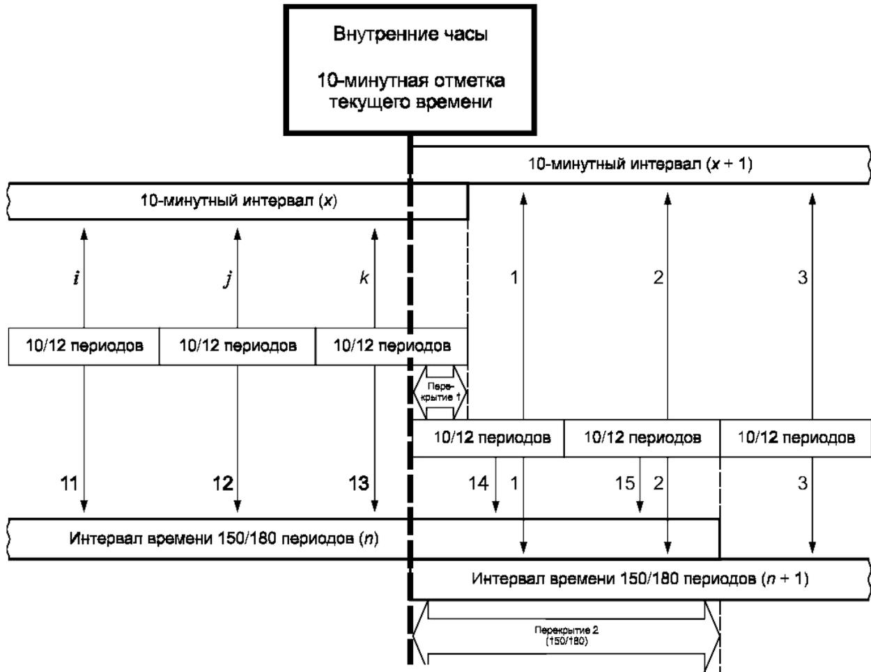
Рисунок 4.2.20. Выбор длительности периода и времени измерения
