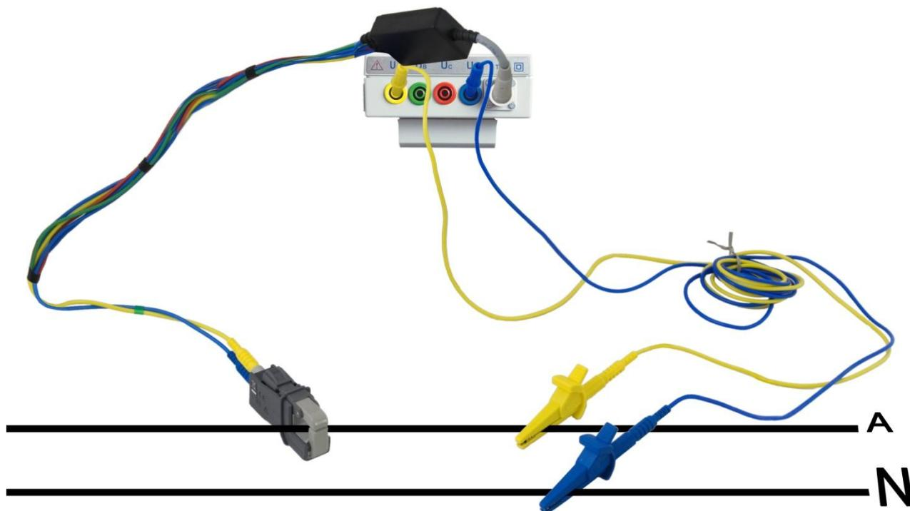
Рисунок Б5 Схема подключения Энерготестера ПКЭ-А к однофазной двухпроводной сети
