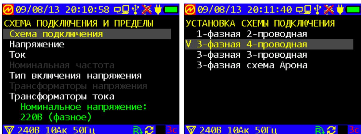
Рисунок 4.4.2 Экраны для выбора схемы подключения Энерготестера
