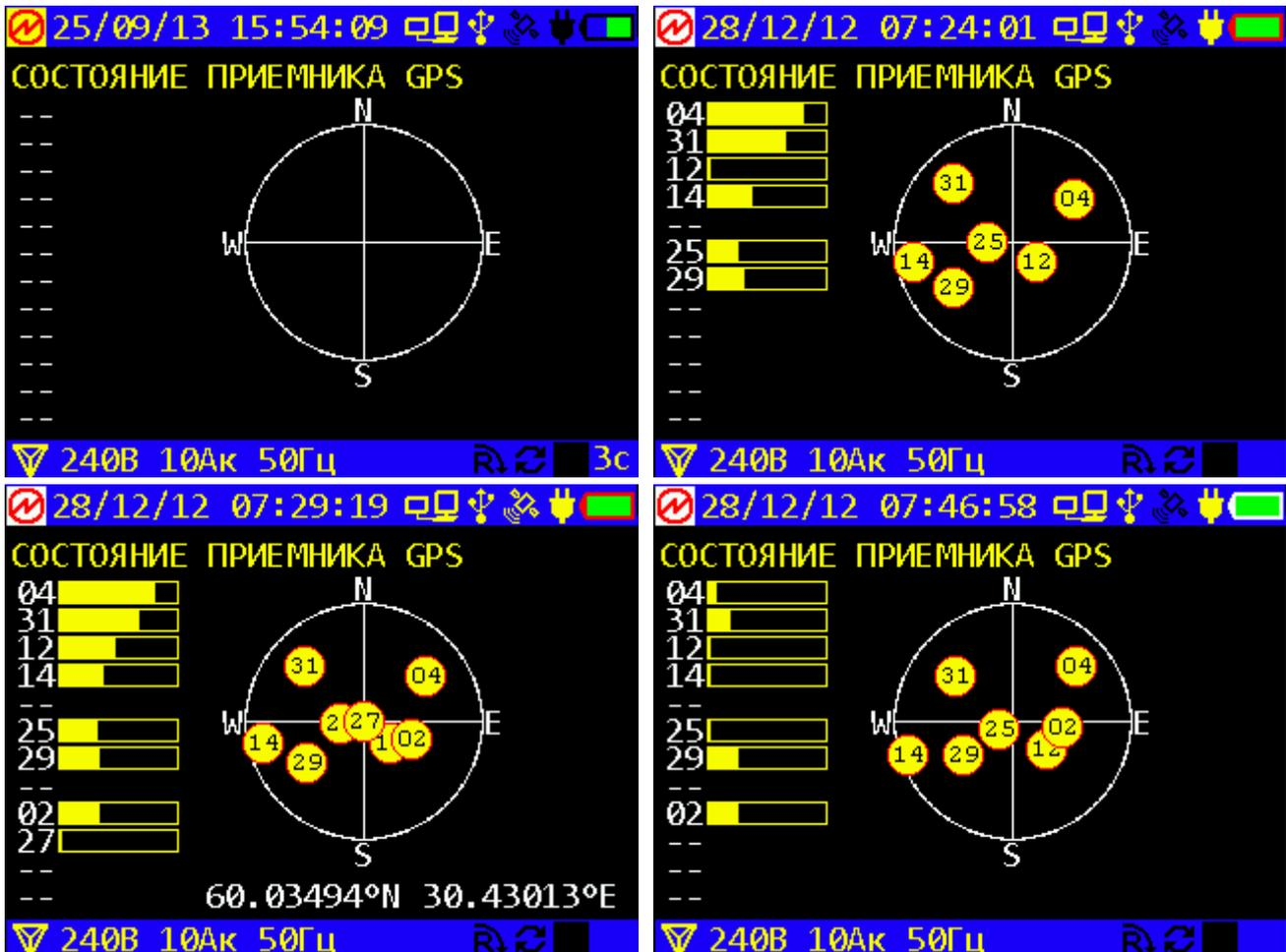
Рисунок 4.5.2 Отображение состояний приемника GPS
