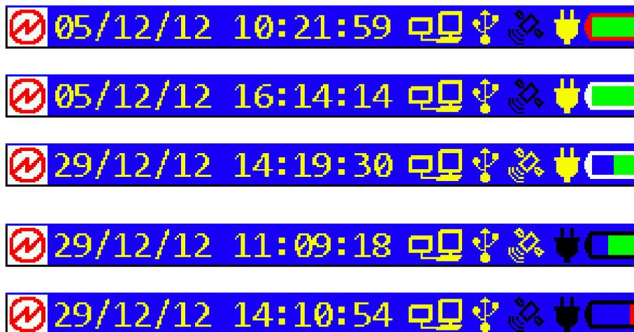
Рисунок 4.1.2 Символы верхней строки состояния Энерготестера ПКЭ
