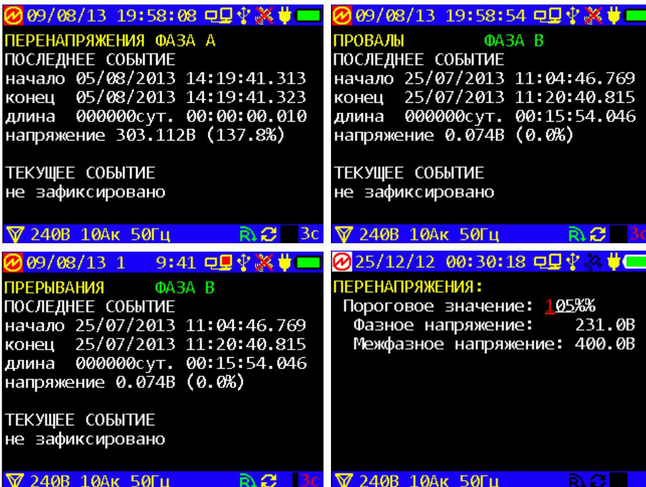
Рисунок 4.2.15. Один из экранов для просмотра случайных событий
