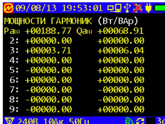
Рисунок 4.2.12. Пример экрана «Мощности гармоник» из подменю «Гармоники и интергармоники»(4 штуки)
