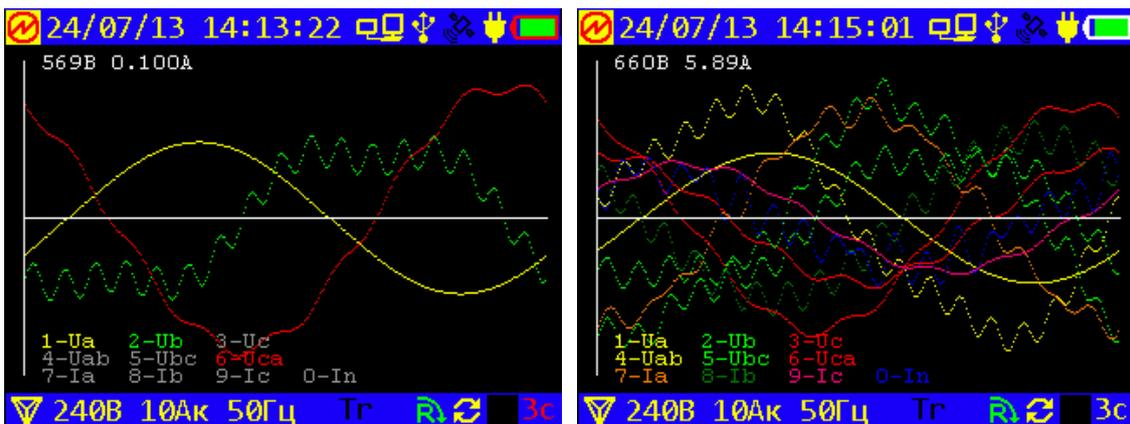
Рисунок 4.2.13 Режим отображения формы сигнала
