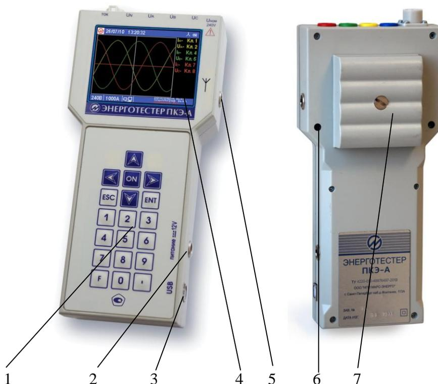
Рис. 3.2. Лицевая и задняя панели Энерготестера ПКЭ-А.
