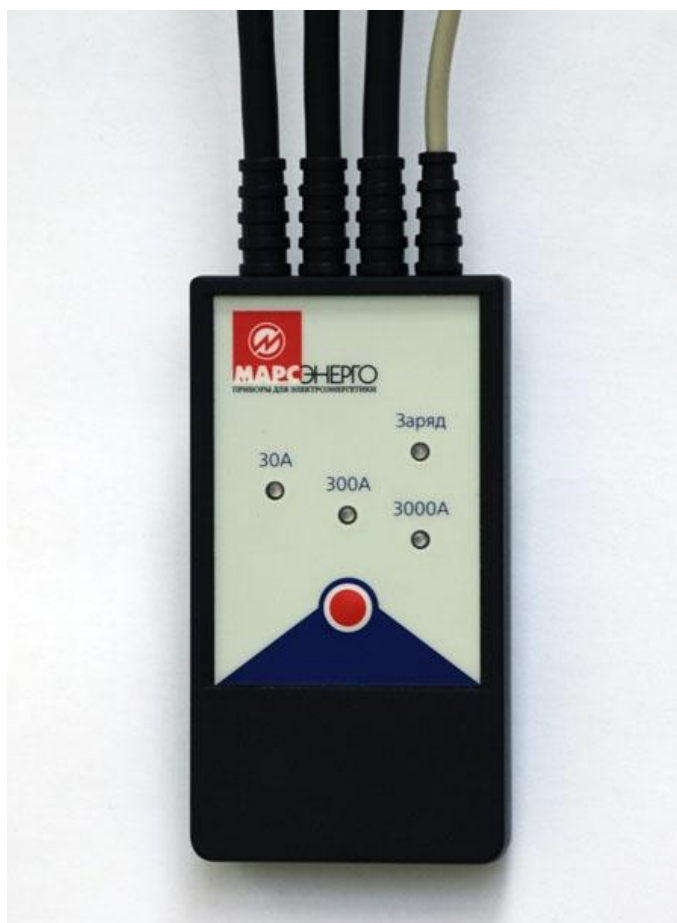
Рис. А.7. Трехдиапазонный усилитель токоизмерительных клещей на 30 / 300 / 3000 А с выбором рабочего предела
