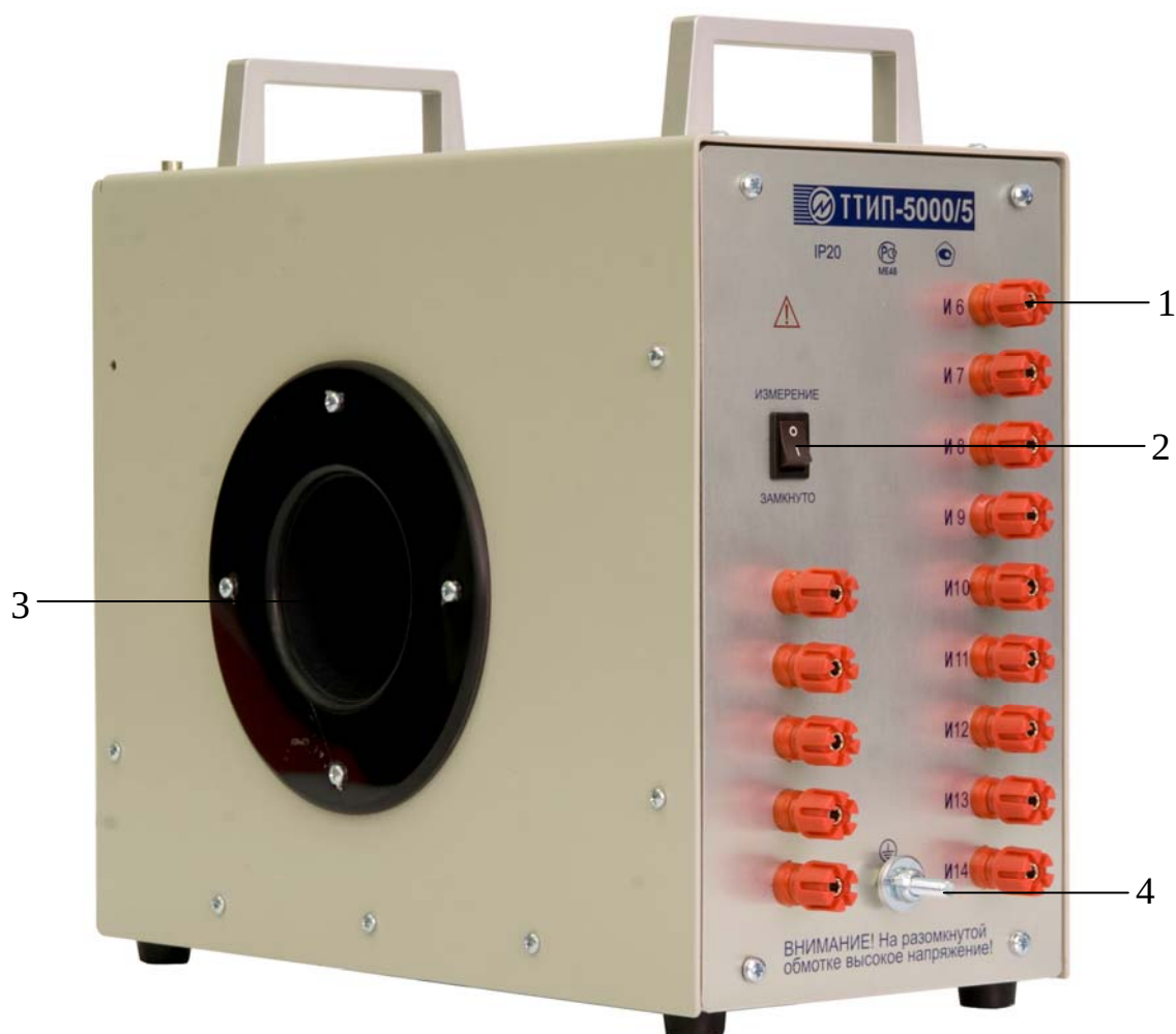
Рис. 2.1. Внешний вид ТТИП-5000/5:
