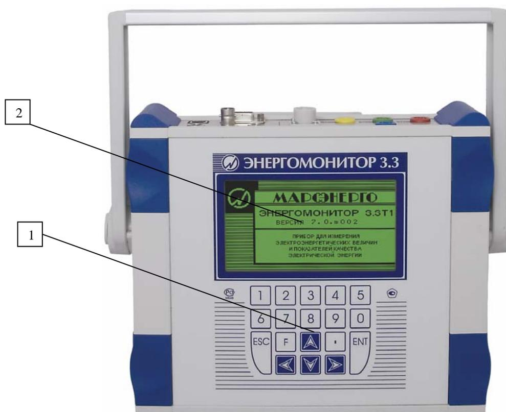
**Рисунок 2.1** Лицевая панель прибора «Энергомонитор-3.3Т1»
