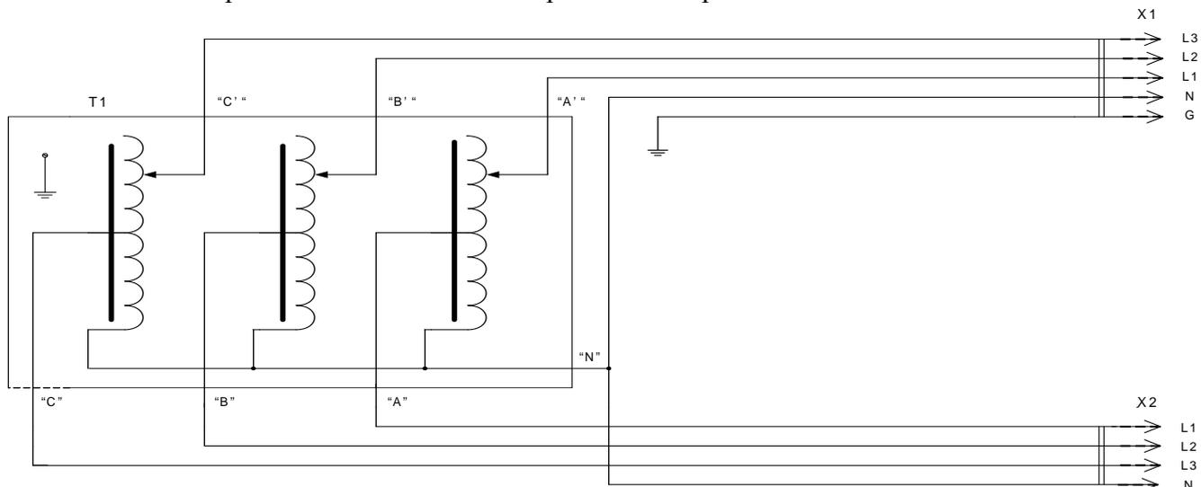
Рис. 3. Электрическая схема блока ЛАТР
