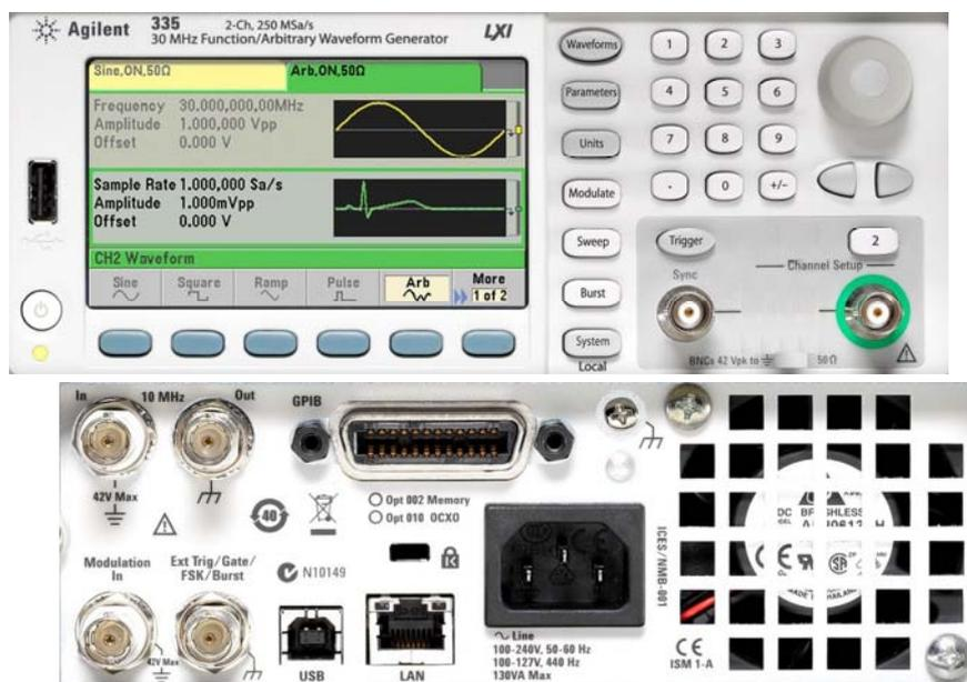
Рисунок 2.4 - Генератор сигналов произвольной формы "33521В"
